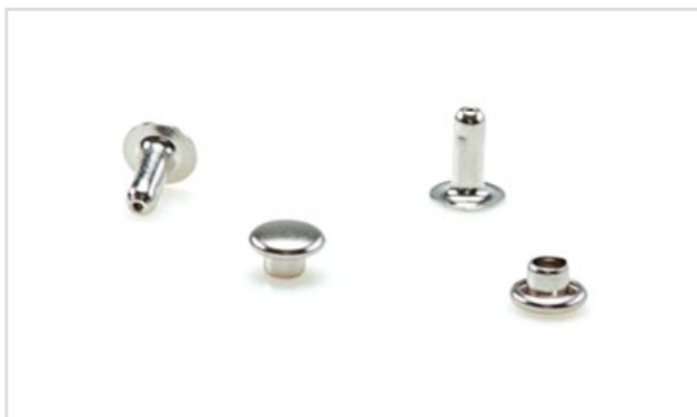
REFERENCIA: Rebite 1,0 PE 7,5mm DESCRIPCIÓN: Remache 1,0 PE 7,5mm MATERIAL: Latón DIMENSIONES: 7mm (cabeza) 7,5mm (altura)
